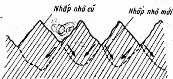
Hình 2-5. Quá trình ăn mòn hóa học trên lớp bề mặt chi tiết máy.
