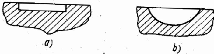
Hình 6-14. a) Rãnh then bằng khi gia công phải dùng dao phay ngón, năng suất thấp; b) rãnh then bán nguyệt khi gia công dùng dao phay dĩa có năng suất cắt cao hơn dao phay ngón.
