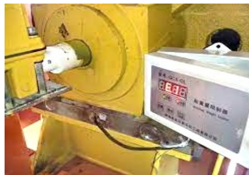
Hình 8. Cảm biến tải lắp ở dưới gối đỡ trục tang
