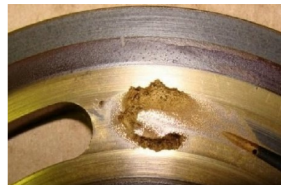
Hình 3. Đĩa bơm bị xâm thực
