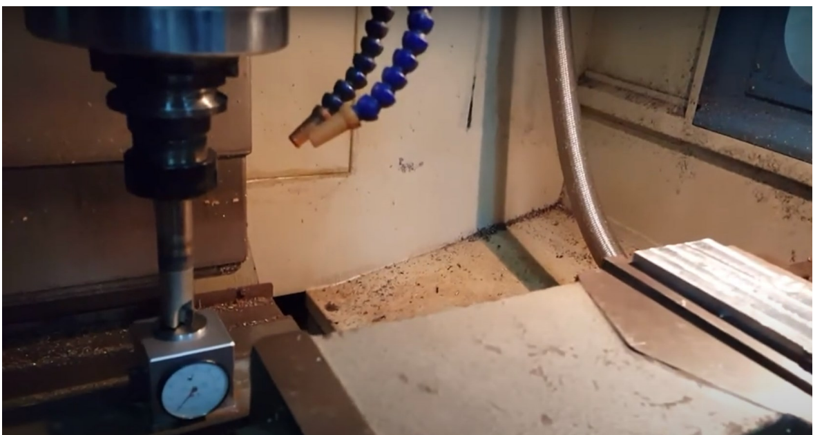
Hình 3. Sử dụng thiết bị so dao để xác định chiều dài dao
